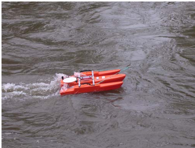
Abbildung 3: ADCP im Einsatz (Foto: Schatzl, 2005)
