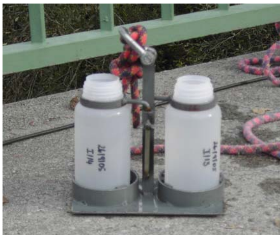
Abbildung 2: Probenentnahmegesetz mit 2 eingesetzten 1 l Probeflaschen
