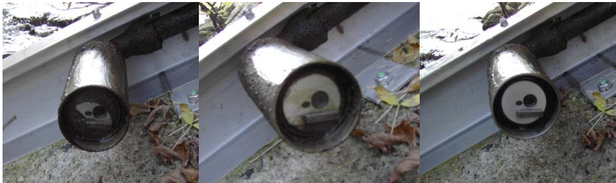
Abbildung 19: Fouling durch Algenbewuchs im Wischerbereich der Sondenoptik (links und Mitte), rechts nach der Reinigung
