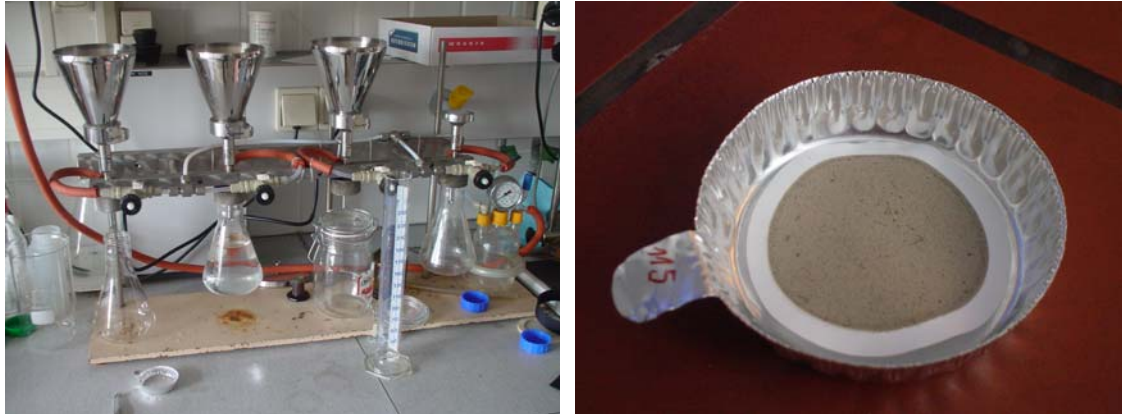
Abbildung 1: Vakuumfiltrationsanlage und getrockneter Filter mit Rückstand (Fotos: Altenhofer, 2005)
