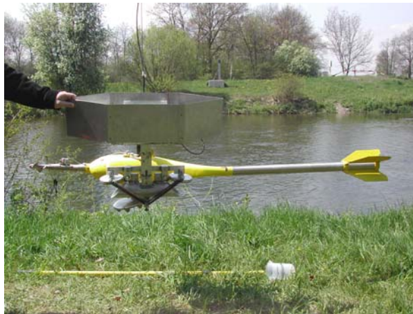
Abbildung 5: IHWW-Schwebstoffentnahmegesetz mit Funkauslösung zur simultanen Entnahme und Geschwindigkeitsmessung (Foto: Kasess, 2004)
