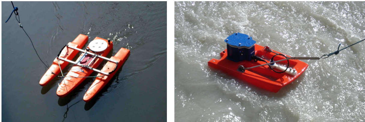
Abbildung 4: links: Geräteträger „Trimaran“ des ADCP-Gerätes „Workhorse Rio Grande ZedHed“; rechts: ADCP-Gerät „Stream Pro“ der Firma RD Instruments
