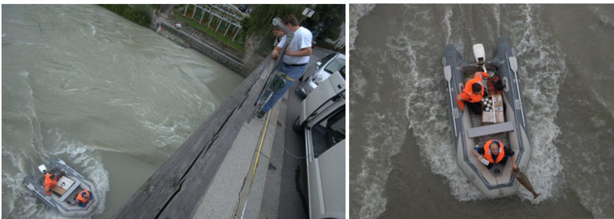
Abbildung 4: Schwebstoffmessung an der Messstelle Schärding/Inn (Foto: Wakolbinger)
