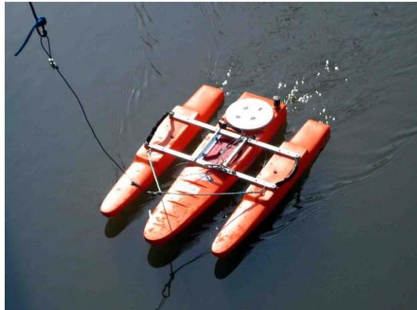
**Abbildung 3-5: Geräteträger „Trimaran“ des ADCP-Gerätes „Workhose Rio Grande ZedHed“ des Hydrographischen Dienstes Steiermark während der Messung**
