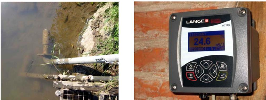
Abbildung 4-9: Sonde Solitax ts-line (links) und Controller sc100 (rechts)
