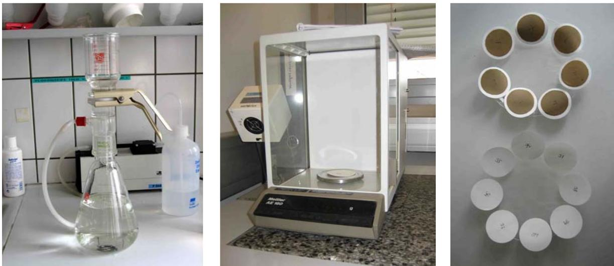
Abbildung 3-8: links: Filtriergerät mit Pumpe im Hintergrund; Mitte: Analysenwaage; rechts: belegte Filter (oben) und neue Filter (unten)
