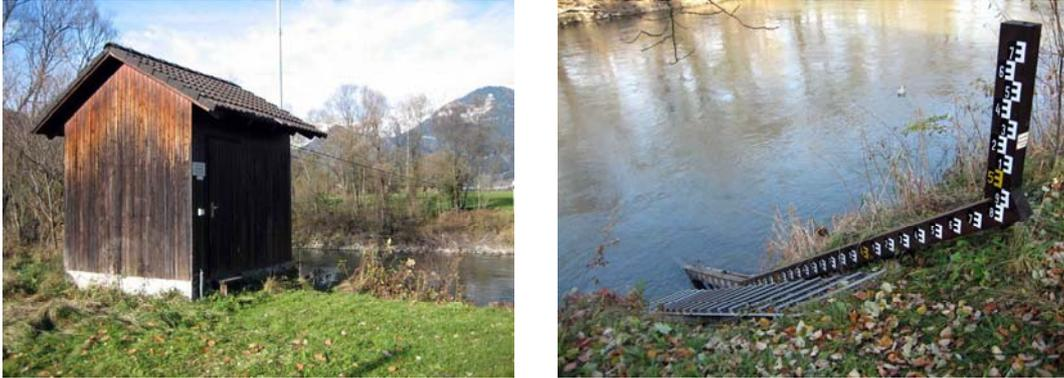
**Abbildung 4-4: Pegelhaus (links), Lattenpegel und Pegelstiege (rechts) Messstelle Admont/Enns**
