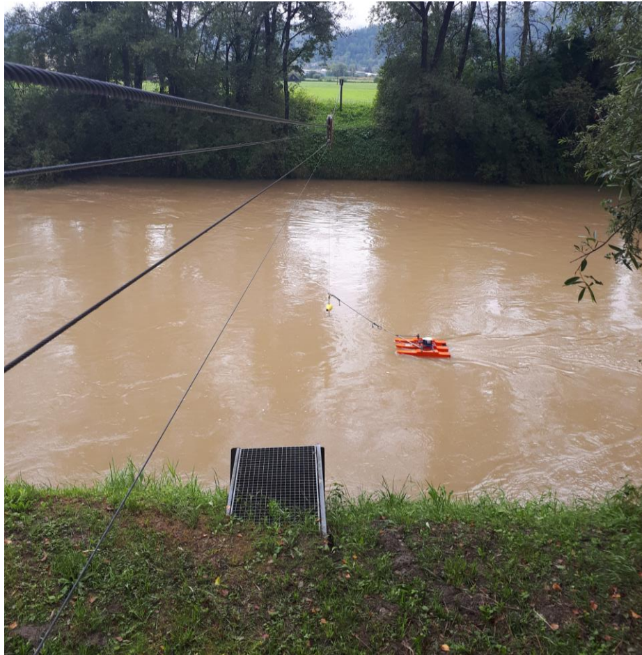
Abb. 12: ADCP-Messung in der Enns
