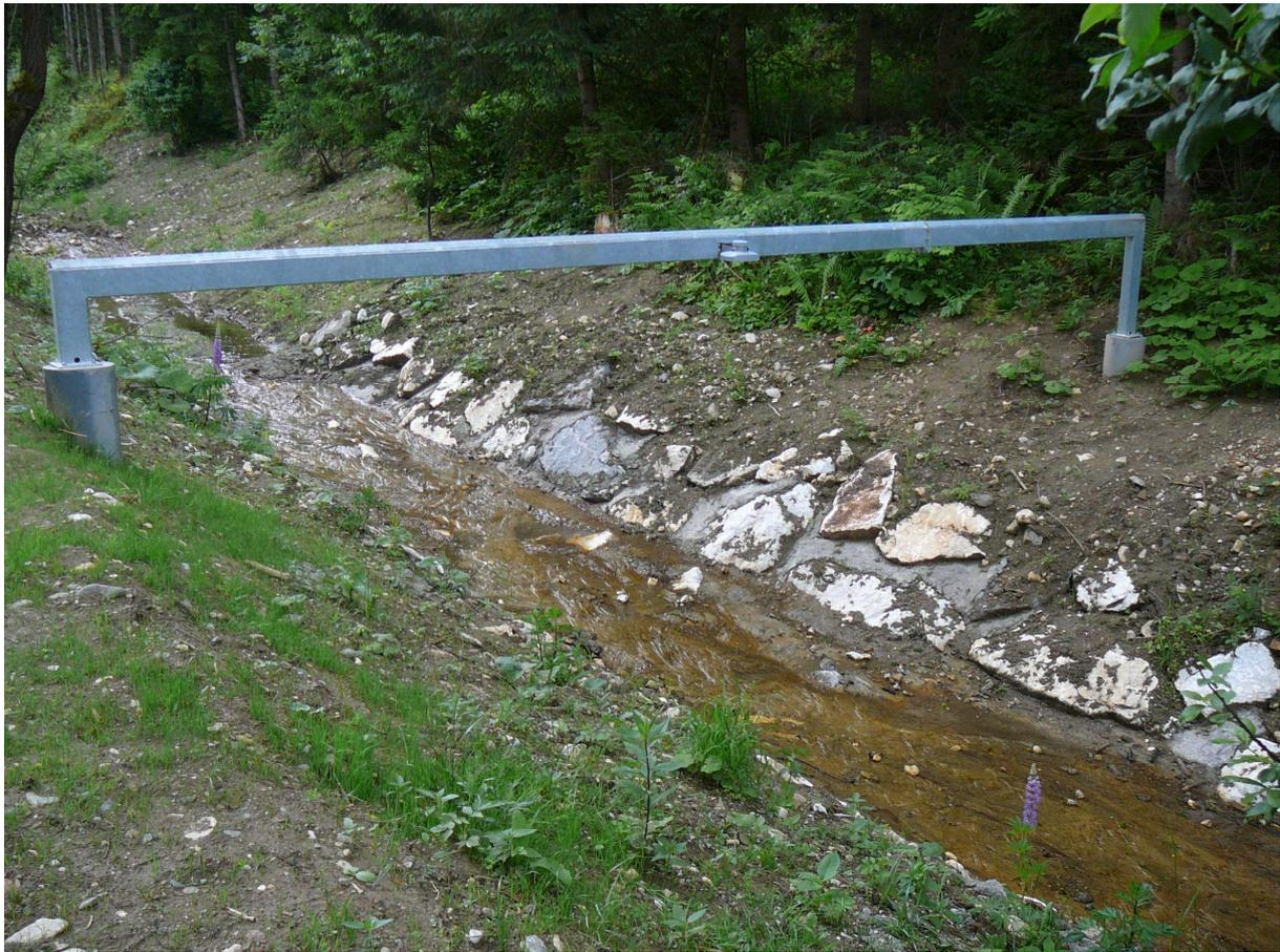
Abb. 12: Radarsensor am Mittergrabenbach (Zubringer zum Granitzenbach) oberhalb eines Rückhaltebeckens
