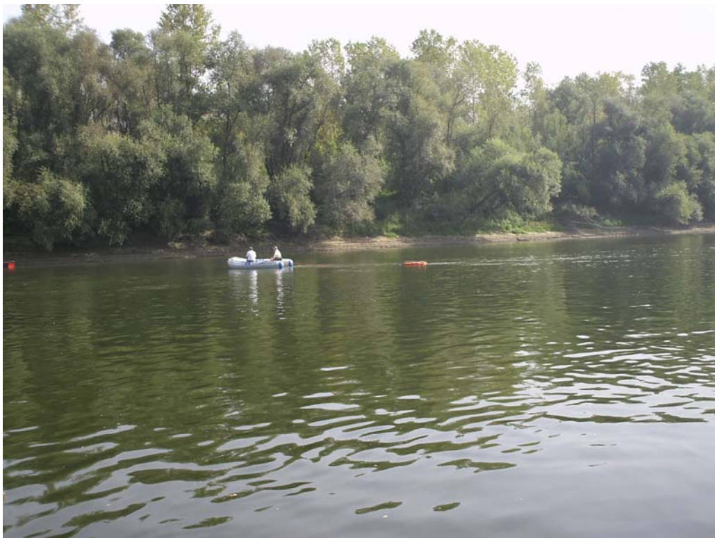
Abbildung 6: Messdurchführung: ADCP's werden mit den Schlauchbooten über das Messprofil gezogen
