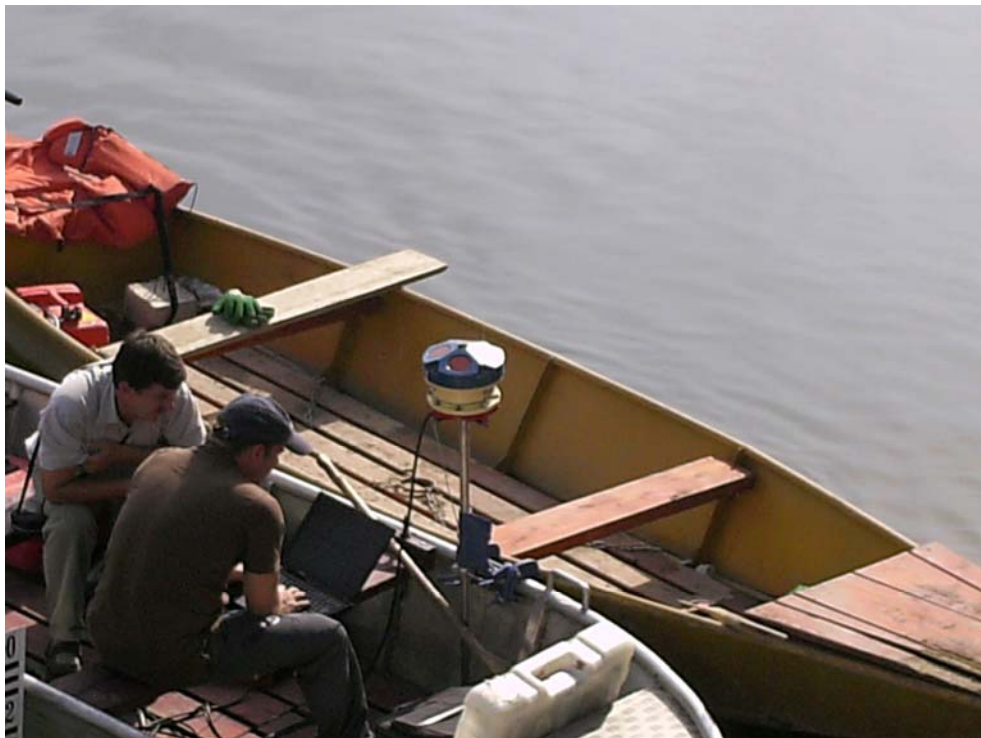
Abbildung 4: Das Boot der ungarischen Kollegen mit fix montiertem ADCP-Sensor
