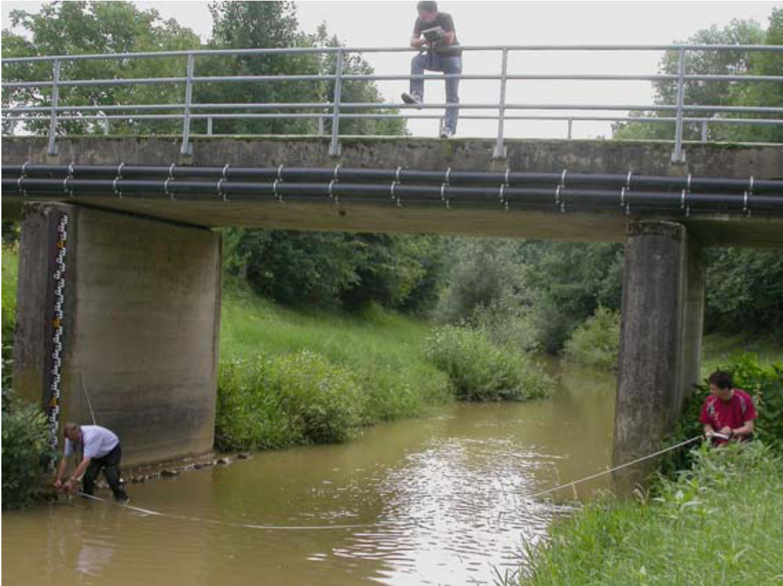
Abbildung 3: Flügelmessung am Messpunkt Saßbach, 14. Juli 2005, Photo Ruch, Richtung SE
