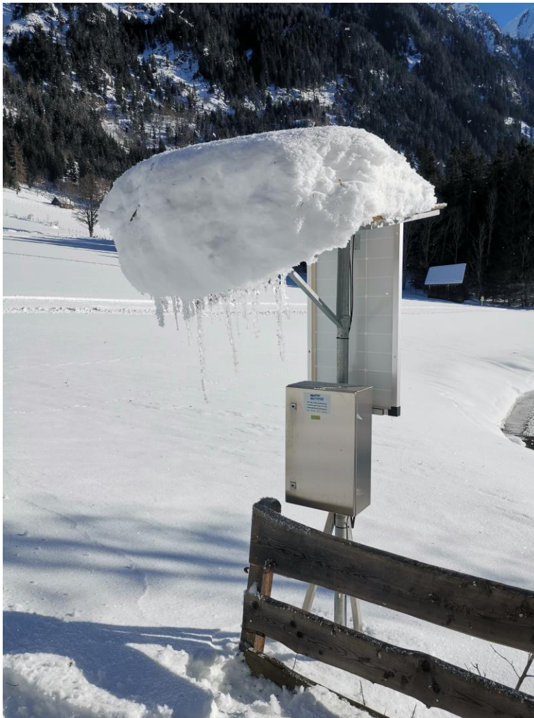
Abb. 13: Pegelmessstation in Tetter (Untertalbach)
