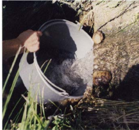
Abbildung 4-3: Gefäßmessung mit Kübel an der Messstelle Saubach (s16) am 20.06.2003
