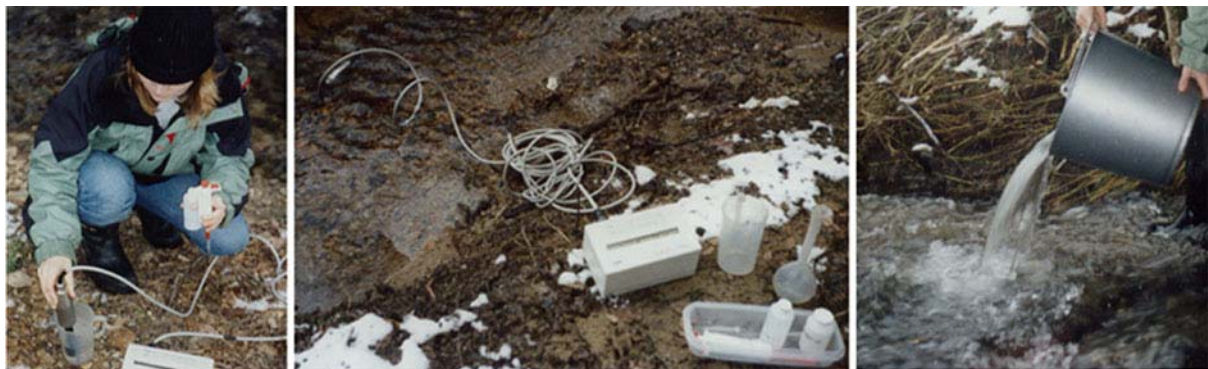
Abbildung 4-6: links: Kalibration - dabei wird das Gerät mit Hilfe einer Eichflüssigkeit vorbereitet für die Tracermessung; Mitte: Einbringen der Sonde in das Fließgewässer; rechts: Einbringen der NaCl-Lösung in das Fließgewässer. Dezember 2002, verschiedene Messstellen.
