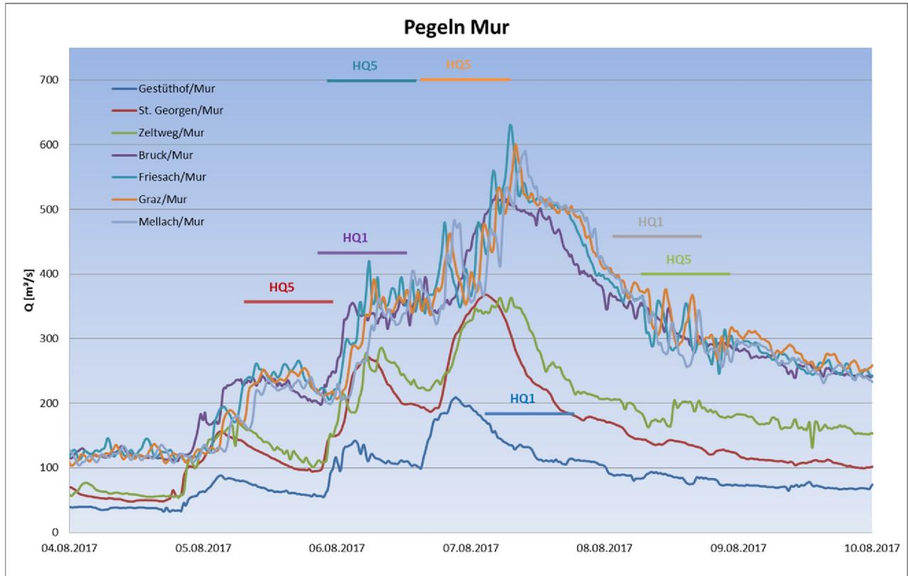
Abbildung 12: Durchflussganglinien an den Pegeln der Mur vom 4.8. bis 10.8.2017
