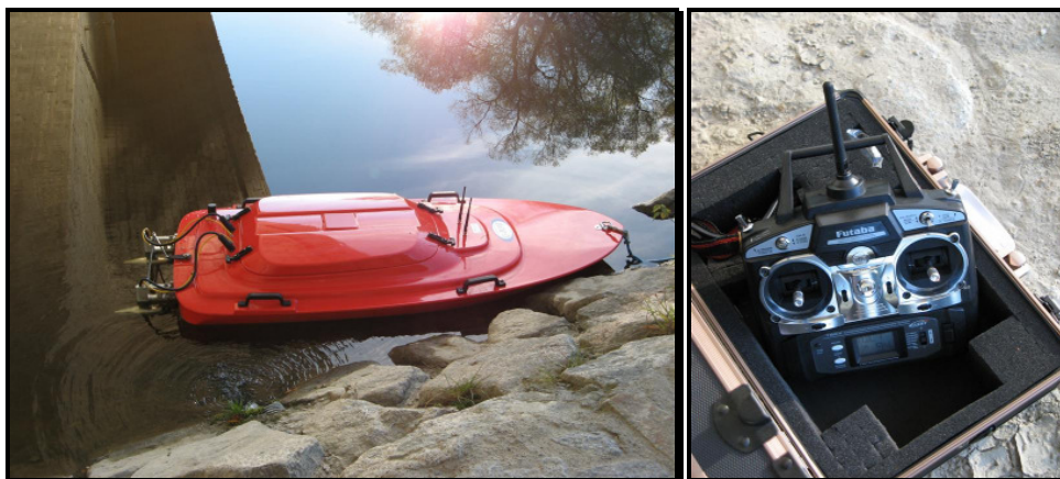
Abb. 5: Messung mit Q-Boat 1800, links zu sehen die Außenbordmotoren, rechts die Bedienung mit Joy-Stick Fotos: HD Tirol
