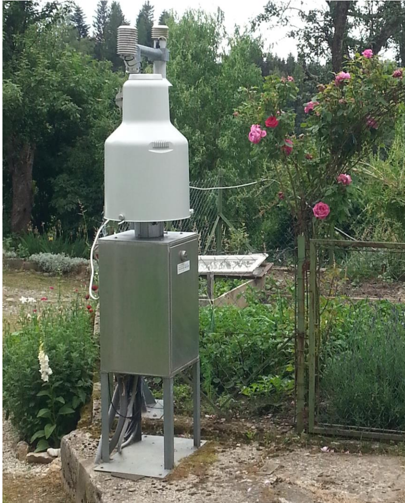
Abb. 13: Niederschlagsmessstation in Festenburg-Hinterberg
