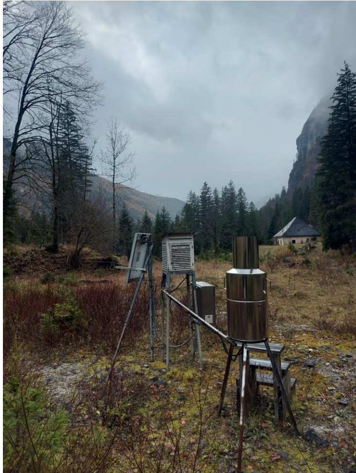
Abb. 13: Niederschlagsmessstation in Seeau
