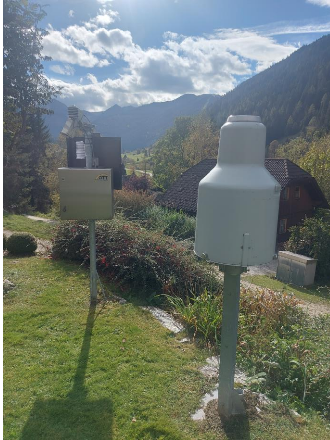
Abb. 13: Niederschlagsmessstation in Donnersbachwald
